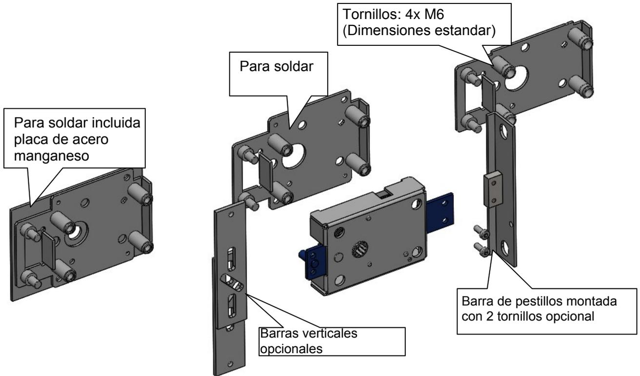
Vista cerrado/abierto de una Primor 100 con placa de montaje con tornillos con barras verticales y barra de pestillos (opcionales)
